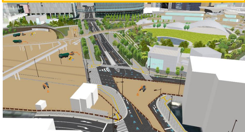
大阪駅北1、2号交差点の仮設通路の動線確認
