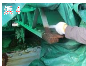
図 4.8 浜中津橋からの試験片採取位置(下流側主構から浜1、浜3、浜5、上流側主構から浜2、浜4、浜6を採取)
