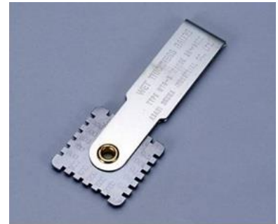
図 4.3 膜厚を測定するウェットゲージ
