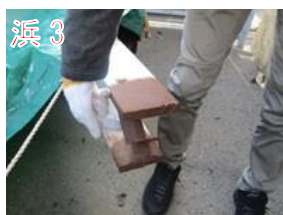
図 4.8 浜中津橋からの試験片採取位置(下流側主構から浜1、浜3、浜5、上流側主構から浜2、浜4、浜6を採取)
