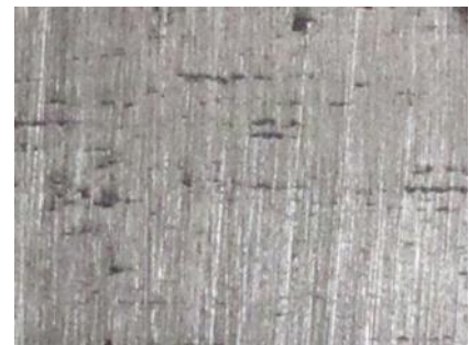
図 5.1 表面に錬鉄特有のスラッグが見られる試験片の例(浜 1)
