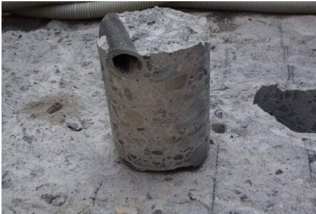
誤って破断させたケーブル管
