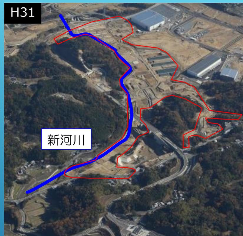
盛土実施に伴い、谷部を流下していた河川の付替工事を実施したため、新たな農業用水源の確保を行った。
