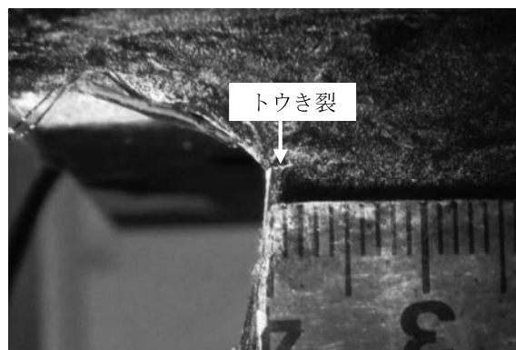
写真3 発見時のトウき裂 (試験部 C 北側, 190 万回)
