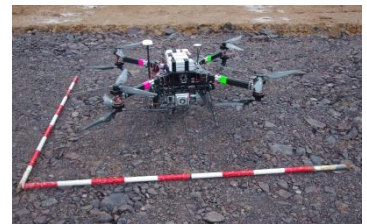
レーザスキャナを搭載したUAV
