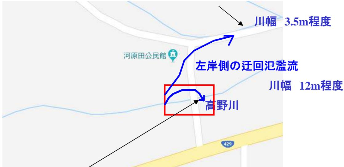
高野川の橋梁前面で流木が集積して閉塞し、氾濫被害発生
