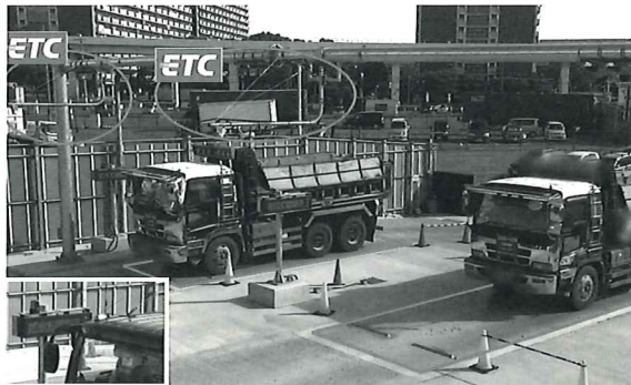
■ETC自動認証中のシールド発生土運搬車両
