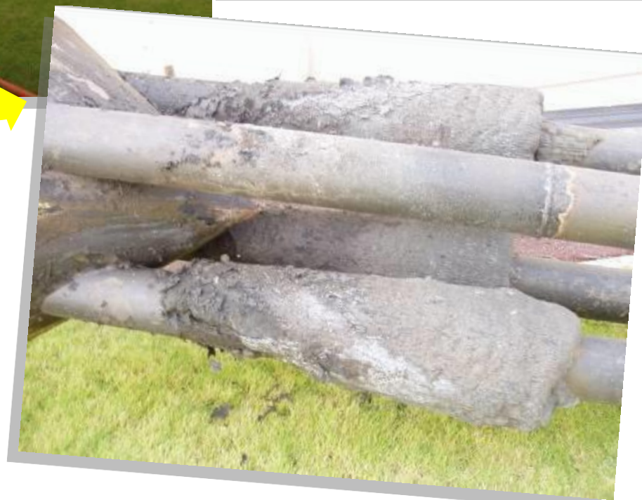
攪拌用ガス吹込管の外に 析出付着したMAP
