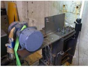
面外ガセット溶接継手試験体
