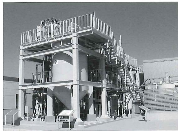
■下水汚泥からリンを直接回収、資源化する装置
