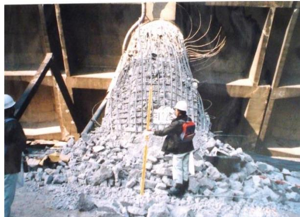
東西面共対称的な破壊形態、基部の外側へのふくらみ少なし
