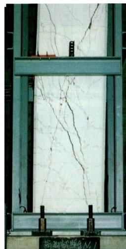
\*斜めひび割れの他に、曲げによる細かい引張りひび割れが水平方向に多数発生
