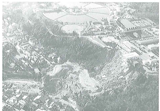
写真-1 仁川の土砂崩れ
