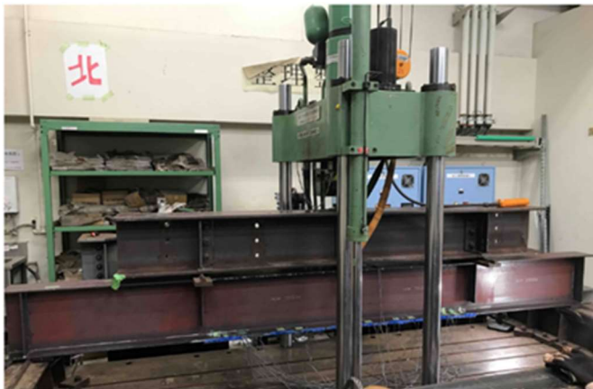
写真4 載荷試験状況 (CFRP 板2m 接着+TRS 補強試験体)
