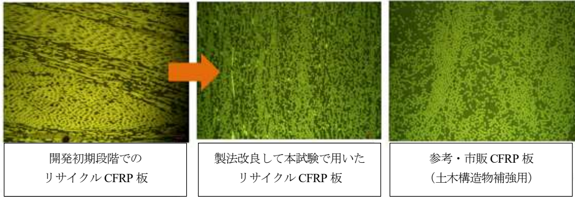
写真2 CFRP 板断面の顕微鏡写真（繊維配向の直角方向断面）
