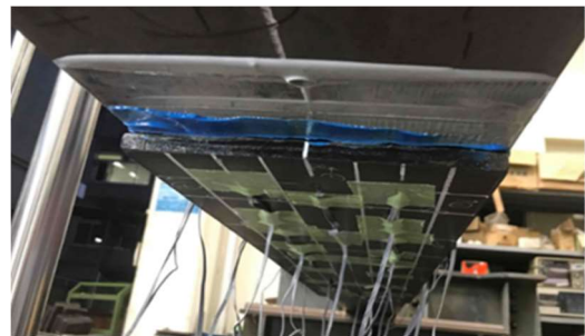
写真5 端部剥離状況 (2m・接着のみ)
