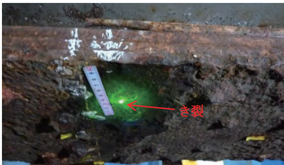
写真5 上部試験体に発生した亀裂①
