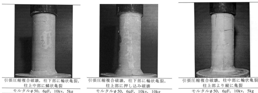
写真10 引張・破壊複合モード ( $\phi$ 50モルタル供試体)
