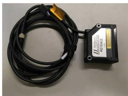
写真 2.1 レーザー式変位計
