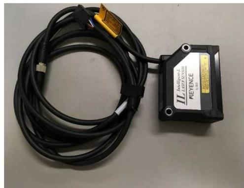
写真 2.1 レーザー式変位計
