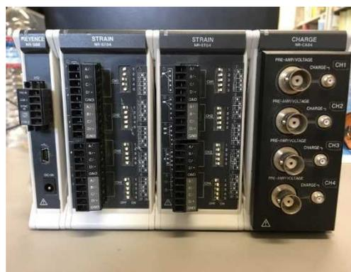
写真 2.2 マルチ入力データ収集システム
