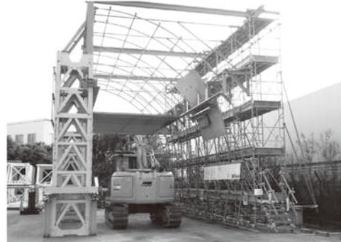
■天井板撤去 実証実験設備
