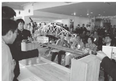
写真3 移動荷重による載荷試験
