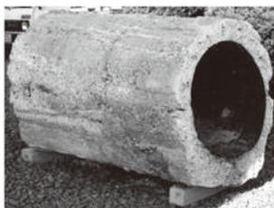
写真-4 創設時の錬鉄管(兵庫県淡河川山田川土地改良区に保管)
