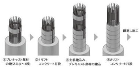
図7 橋脚部 施工方法のイメージ
