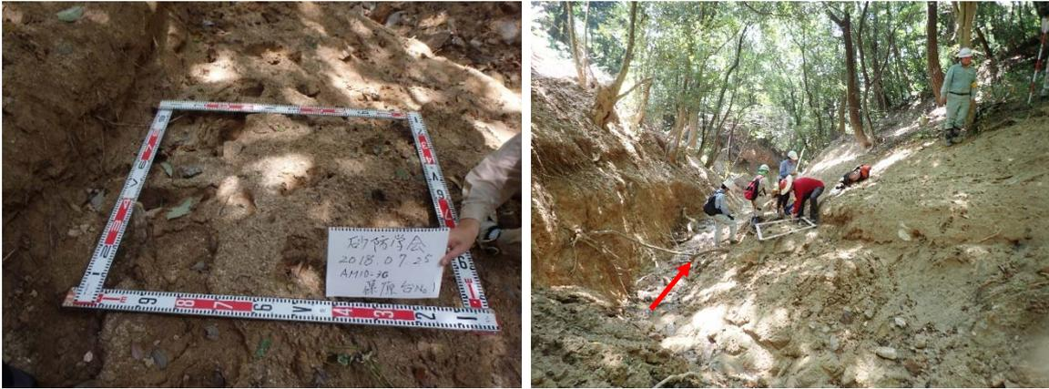
写真-7 堆積土砂の粒度試験試料の採取状況
