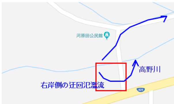
図4 河原田公民館周辺の右岸側迂回流の流路
