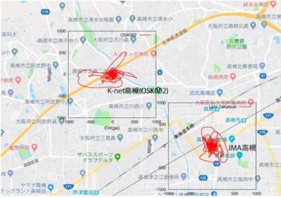
図-34 名神高速道路近くの強震観測記録の加速度軌跡
