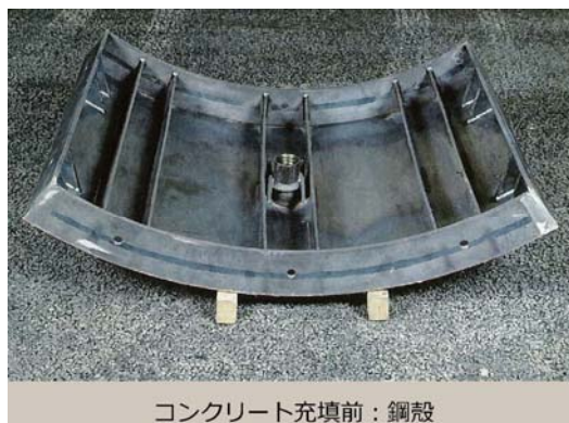
図-2.5.4 合成セグメント概要写真 3)
