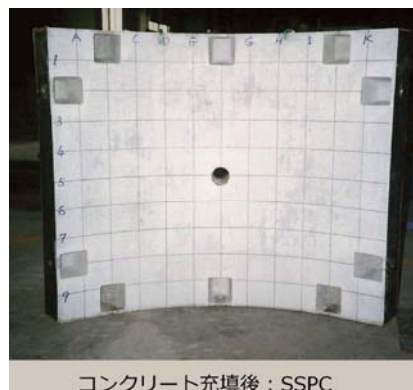
図-2.5.4 合成セグメント概要写真 3)
