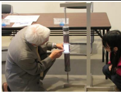
▼ケーブルの振動を計ってます。そこからケーブルにかかっている力がわかります。それ以外にも、異常な音を聞き分けるアプリが入っています。
